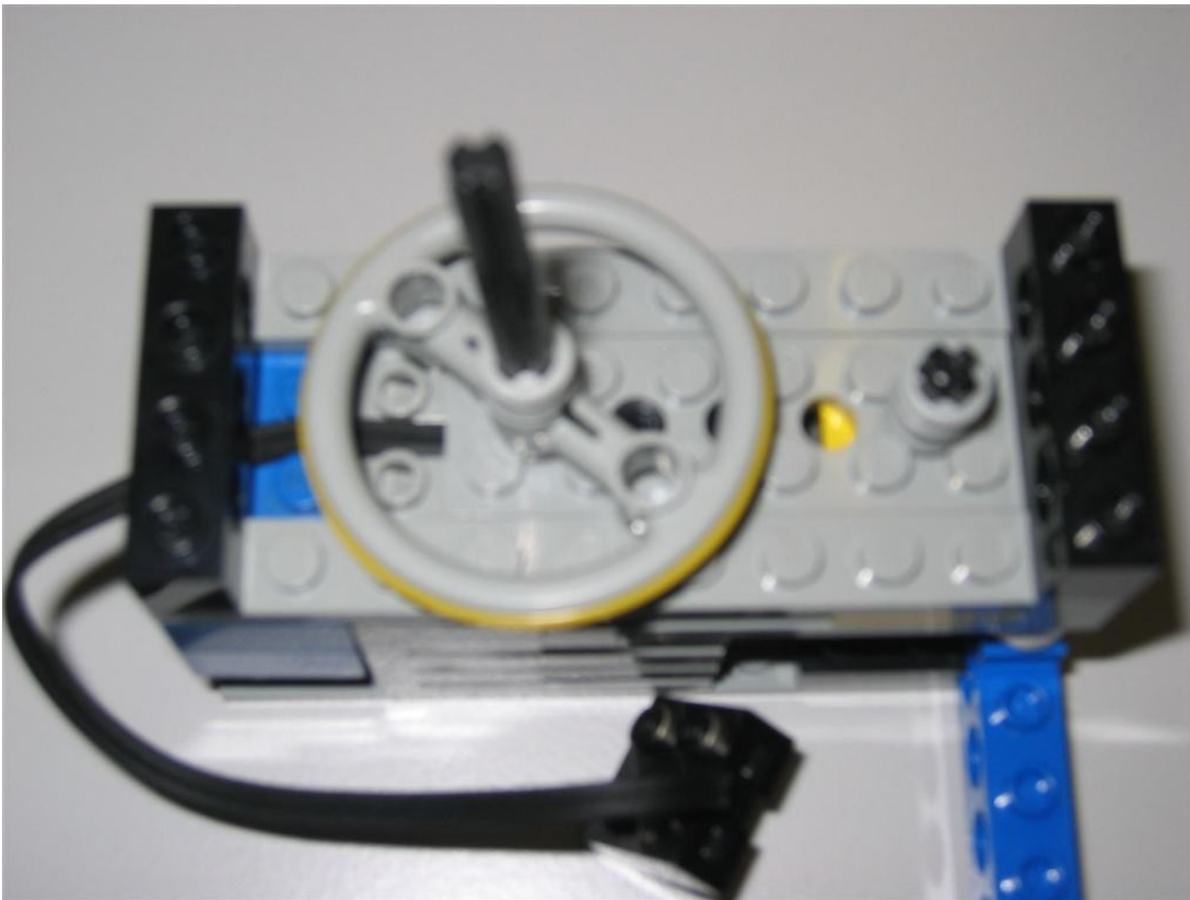
Abbildung 14: Umlenkung mittels eines Gummis
