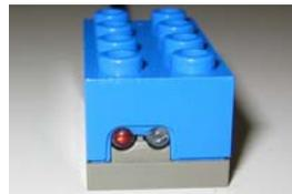
Mit dem Rotationssensor kann man messen, wie stark sich die Achse gedreht hat.
