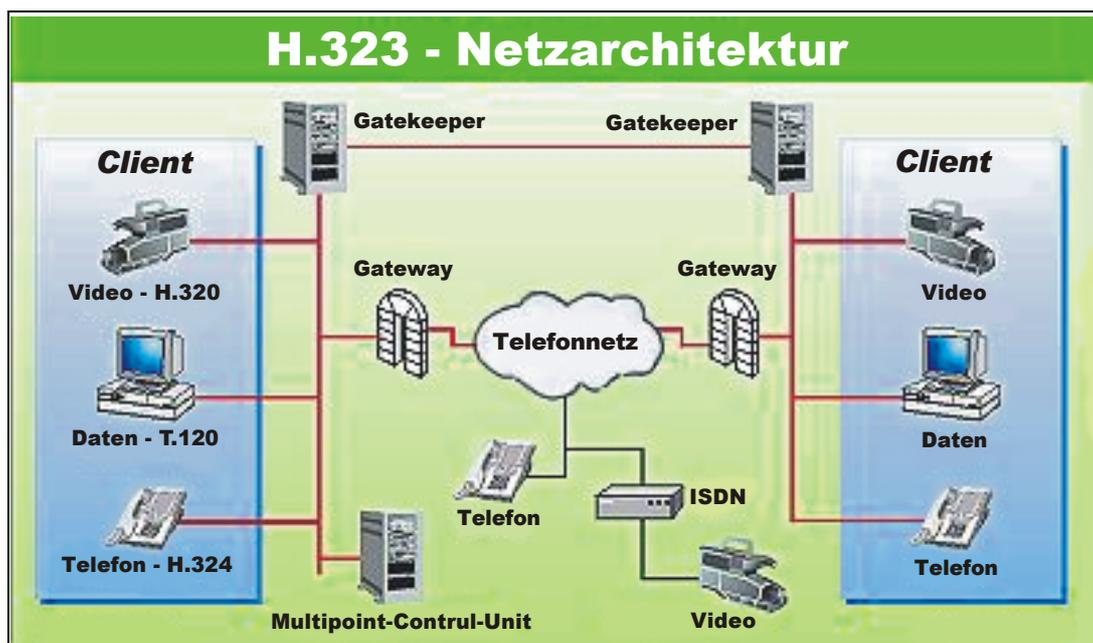
Fig. 2 H.323-Netzwerkmodul der ITU
